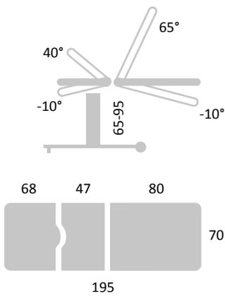
**Jordan H23e** - 3teiliger gynäkologischer Stuhl, die elektrische Höhenverstellung ist von 65 cm – 95 cm manuell mittels Fußschalter einzustellen, der Rückenteil ist elektrisch von -10° bis + 65° und der Sitzteil ist von -10° bis + 40° neigbar. Die Griffe sowie der Fußteil sind abnehmbar, die Kopfstütze ist verschiebbar. Der am Rückenteil befestigte Papierrollenhalter, die Edelstahlschale unterhalb des Sitzes sowie die verchromten Bügel machen den Stuhl komplett.
